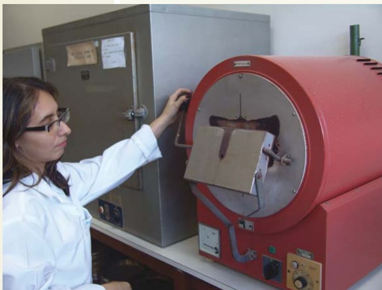
Calcinando amostras de argilo-minerais
