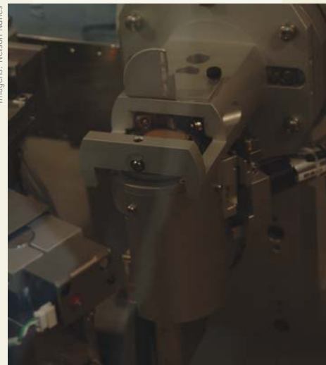
Vista interna do difratômetro de raio X
